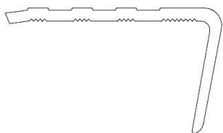
Die 1214 — 48mm Flexible PVC Rakeback
